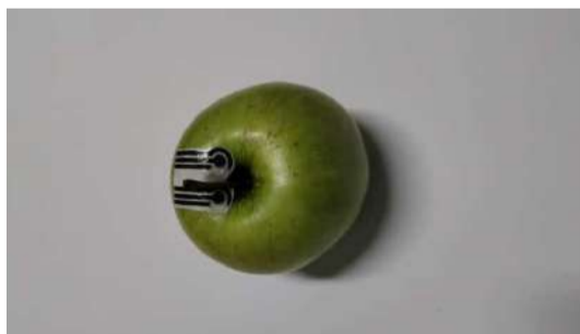
O sensor “vestível” tem a vantagem de ser aplicado diretamente na amostra, pois o acetato consegue adquirir o formato da superfície em que é posicionado (imagem: Nathalia Oeazu Gomes)
